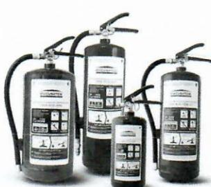
**При тушении пожара необходимо:** поднести огнетушитель к месту пожара, выдернуть чеку, направить рукав на очаг пожара, нажать на ручку запорно-пускового устройства. Дальнейшее управление работой огнетушителя осуществляется путем нажатия кистью руки на ручку ЗПУ, при этом огнетушащее вещество через гибкий шланг подается на очаг пожара.
