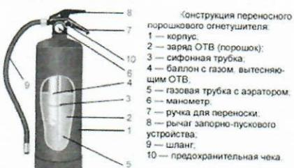
Здания университета оснащены переносными огнетушителями: порошковые, углекислотные, воздушно-пенные, воздушно-эмulsionционные.
